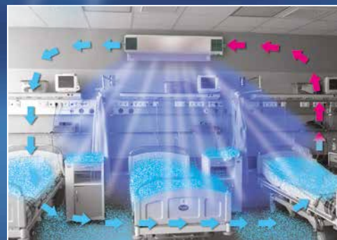
Proces oczyszczania powietrza promiennikami wewnętrznymi – funkcja I i zewnętrznymi – funkcja II (powietrze i powierzchnie)
